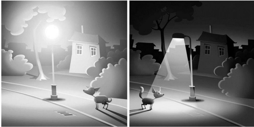
Abb. 4-21: Illustration der Abstrahlungsgeometrie. Links: Darstellung einer Kugelleuchte, ohne Abschirmung. Rechts: abgeschirmte Straßenleuchte. © Rainer Stock im Auftrag des „Loss of the Night“ Networks LoNNe (EU-COST-Aktion ES1204)
