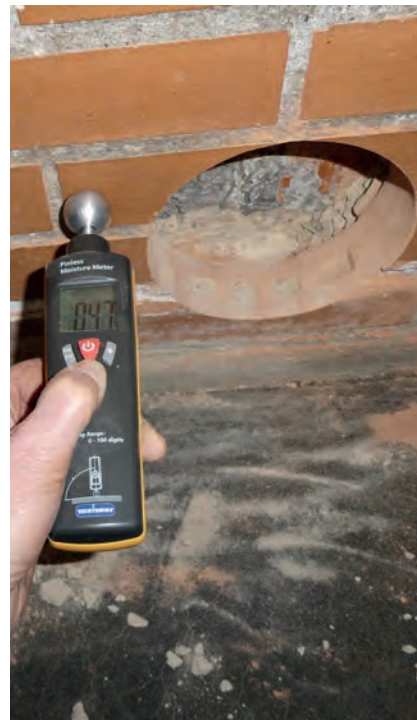
Foto 119: Sporthalle – nördliches Hallendrittel Detailaufnahmen Foto links: Distanz zwischen hallenseitiger Mauerwerks und Betonoberfläche – ca. 8,0 cm Foto Mitte: Feuchtemessung an Ziegelsteinoberfläche – 47 Digits (feucht) Foto rechts: Feuchtemessung an Betonoberfläche – 79 Digits (nass)
