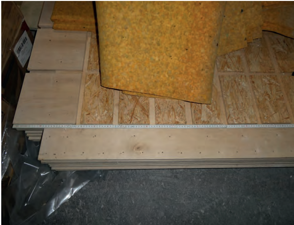
Foto 128: Schulgebäude – Lagerraum im Untergeschoss Detailaufnahme eingelagerte Hallenbodenteile: Sperrholzplatten und Dämmstoffbahnen
