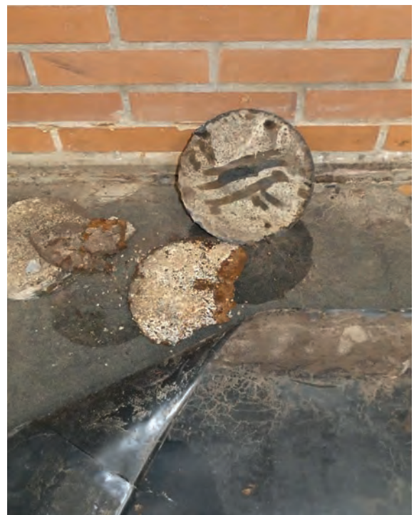
Foto 125: Sporthalle – nördliches Hallendrittel Detailaufnahmen Foto links: Kernbohrung in Hallenboden Foto rechts: mittels Kernbohrung aus Bodenaufbau getrennte Bodenschichtteile
