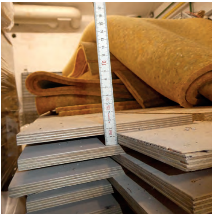
Foto 129: Schulgebäude – Lagerraum im Untergeschoss Detailaufnahme eingelagerte Hallenbodenteile Foto links: Sperrholzplatten, zweilagiger Aufbau Foto rechts: Dicke Dämmstoffbahn ca. 18 mm
