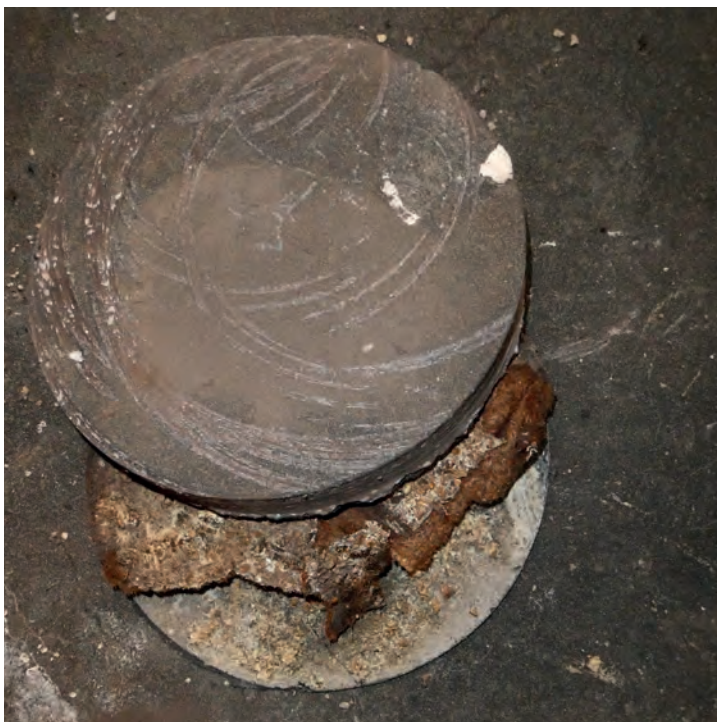
Foto 125: Sporthalle – nördliches Hallendrittel Detailaufnahmen Foto links: Kernbohrung in Hallenboden Foto rechts: mittels Kernbohrung aus Bodenaufbau getrennte Bodenschichtteile
