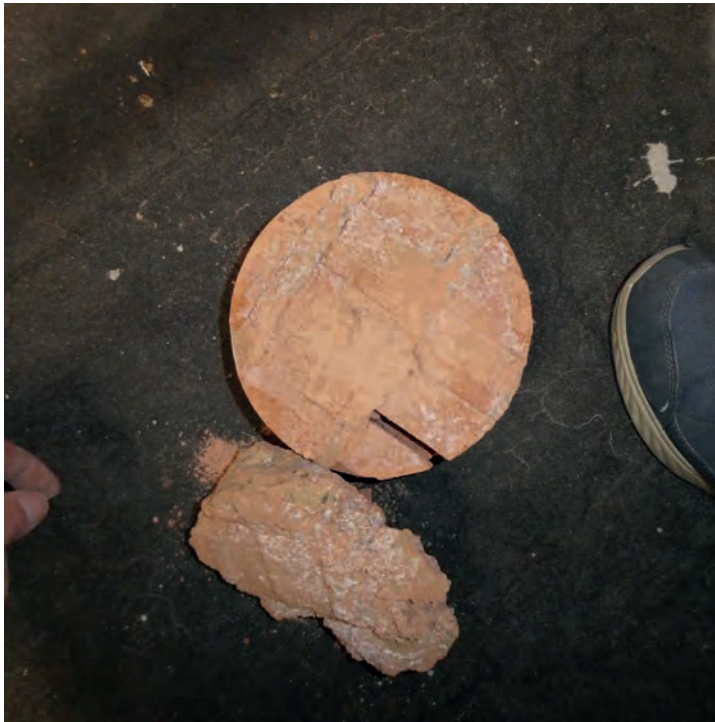
Foto 118: Sporthalle – nördliches Hallendrittel Detailaufnahmen Bohrkern Ziegelmauerwerk und Mörtel Foto links: Bohrkernrückseite Foto rechts: Profilansicht Bohrkern und Mörtelbruchstück
