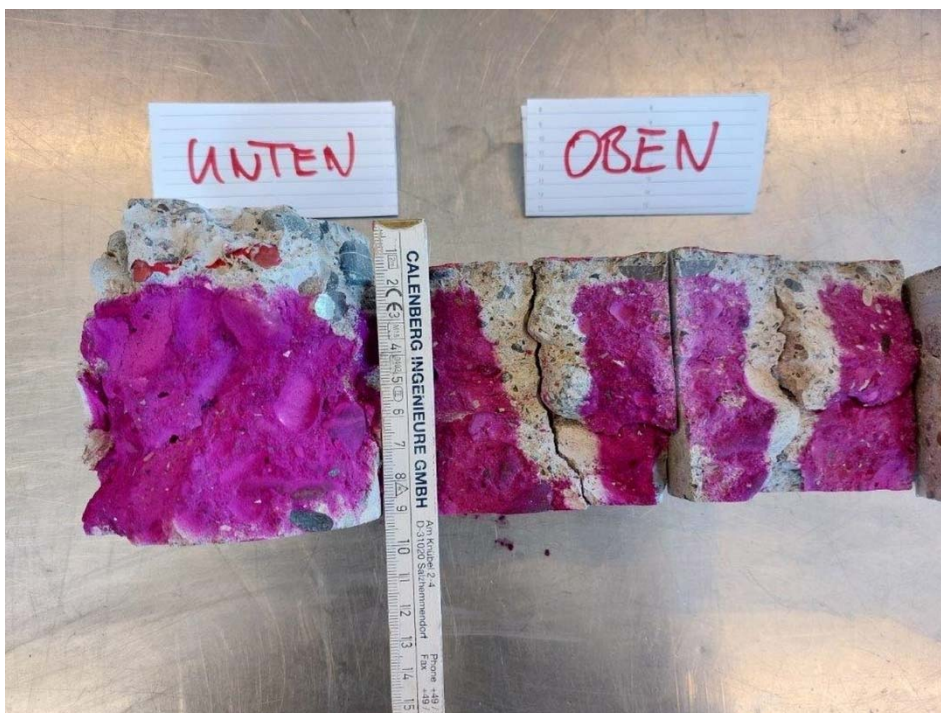
Foto A10: Untersuchungsstelle 8 – Karbonatisierungstiefe oben ca. 8 - 20 mm, unten ca. 30 mm
