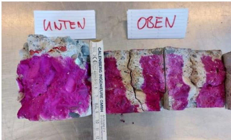
Prüfung der Carbonatisierung an Bohrproben
