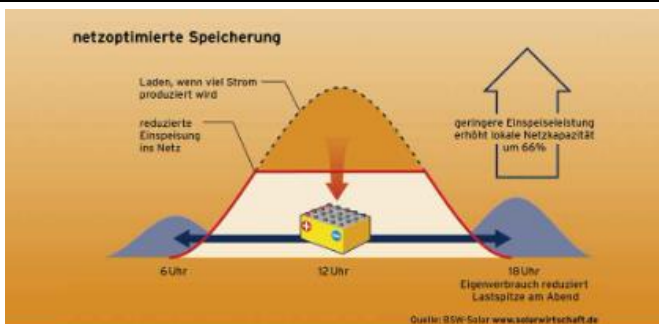
Abbildung: Solarspeicher (Quelle: BSW Solar)
